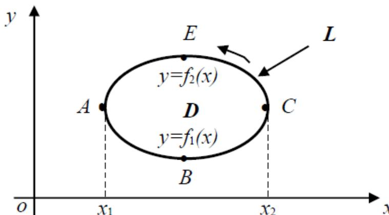
$$\int_{x_1}^{x_2} f_2(x) dx = \int_{AEC} y dx = - \int_{CEA} y dx \quad y \quad \int_{x_1}^{x_2} f_1(x) dx = \int_{ABC} y dx$$
