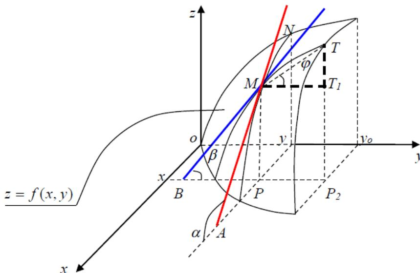
Veamos la interpretación gráfica de la  $\frac{\partial f(x, y)}{\partial y}$ . Para ello tracemos el plano  $x = cte.$ , la intersección de éste con la superficie nos determina la curva  $MT$ .
