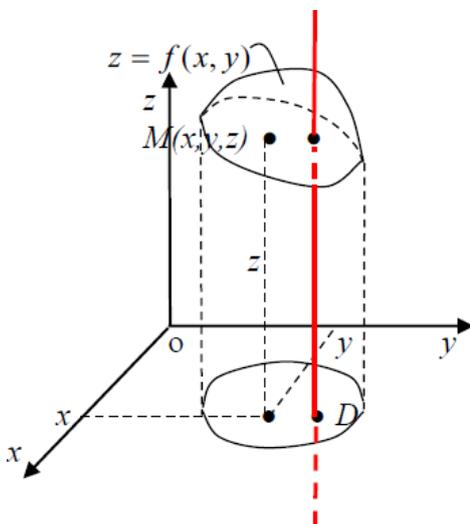
Si por cada punto  $(x, y)$  del dominio  $D$  trazamos una perpendicular al plano  $0xy$ , y tomamos un segmento de longitud igual a  $f(x, y)$  obtendremos en el espacio un punto  $M(x, y, z)$ .
